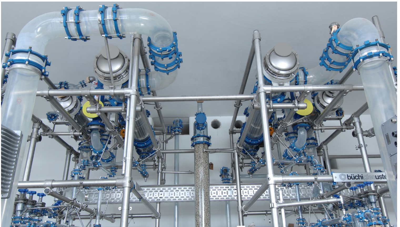
Distillation overhead with SIC shell and tube heat exchangers Destillationsaufbau mit SIC Rohrbündelwärmetauschern
