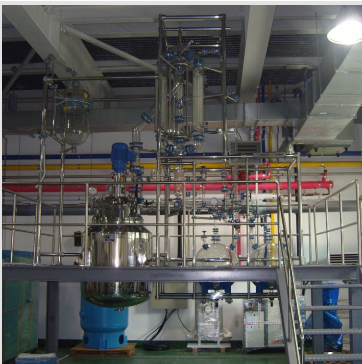
1000 liter cryogenic reactor with glass upper section 1000 Liter Tieftemperatur-Reaktor mit Glasaufbau
