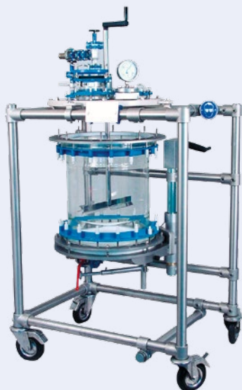
Nutsch filter with manual stirring Nutsch Filter mit Handrührer
