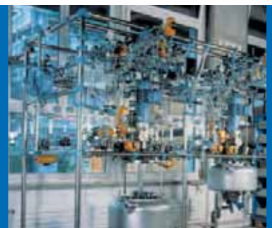
Combination: Pressure reactor with glass overhead Kombination: Druckreaktor mit Glas-Aufbau
