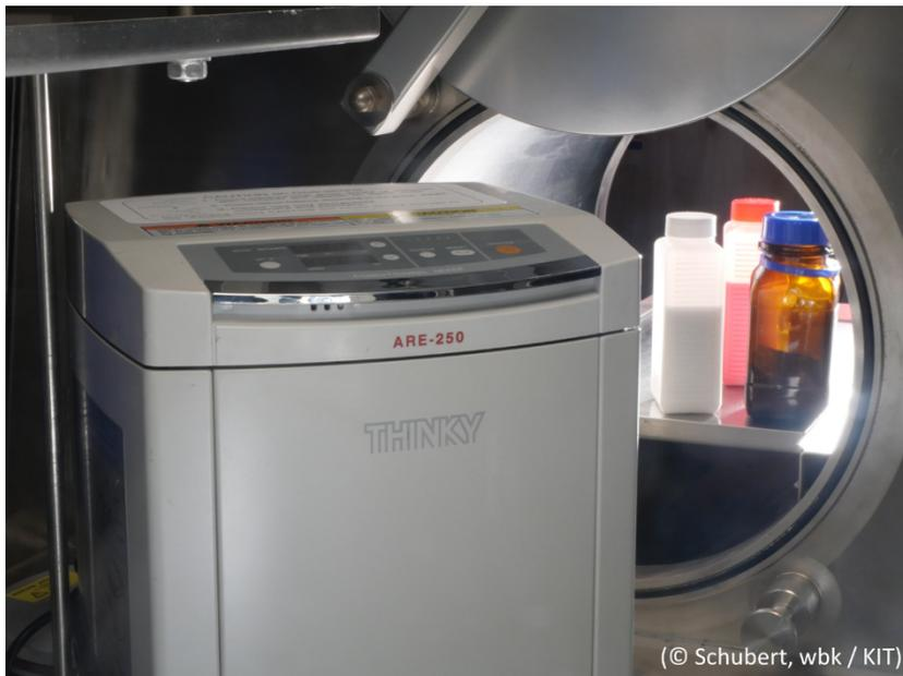
Abbildung 2: Thinky Mischer ARE-250 mit angepasster Schaltplatine in einer Glovebox
