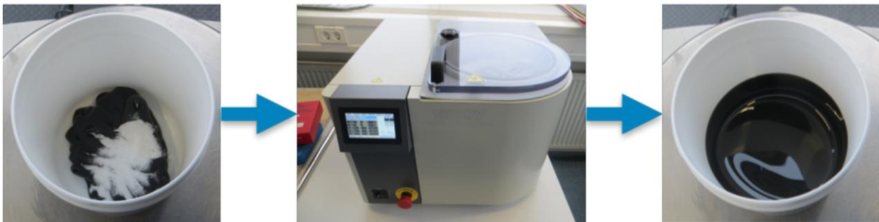
Abbildung 1: Zugabe von 3 Gew.-% Glaskugeln zur Polyol-Komponente des Klebstoffs (links), Mischen im Vakuumzentrifugalmischer (Mitte) und homogenes Mischergebnis (rechts).
