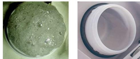
Abb. 4: Hochviskose Silikonmasse – linke Seite Entgasen in separater Vakuumkammer („Überlaufen“ möglich), rechte Seite gleichzeitiges Mischen und Entgasen mit dem Thinky ARV-310
