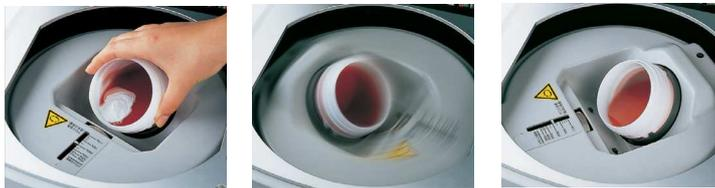
1. Einbringen der Probe in den Mischbehälter
