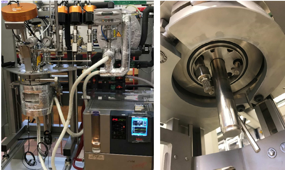
Abbildung 3: linke Seite: Beispiel Druckreaktorsystem mit CO 2 Dosierung, Temperierung und diversen Armaturen; rechte Seite: Unterseite Deckelplatte mit Probenkammern
